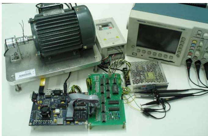
图(五) 基于FPGA的感应电机智能型控制系统实验环境
