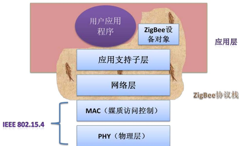
ZigBee 协议栈有“1.75 层”，即“1+0.5+0.25”，1 为完整的网络层(NWL)，0.5 为应用层的下半部分应用支持子层（APSL），以及为于该层之上的 ZigBee 设备对象（ZDO），应用支持子层对它上一层的协议代码，使用一个字节的端口号（EP，End Point）来区分，类似于 TCP/IP 协议栈的 TCP 端口和 UDP 端口，用来区分不同的服务，而 ZDO 使用端点 0，可用的端口为 1~240，240 之后的端口为协议栈保留端口。
