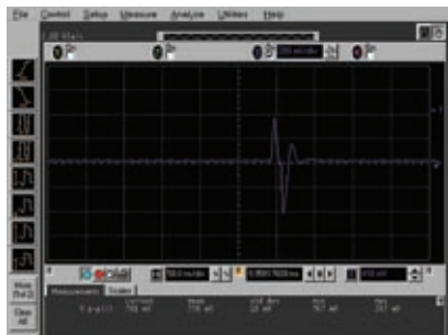
Agilent PIN 开关有该类型开关中低的视频泄漏，典型值为 780 mVpp
