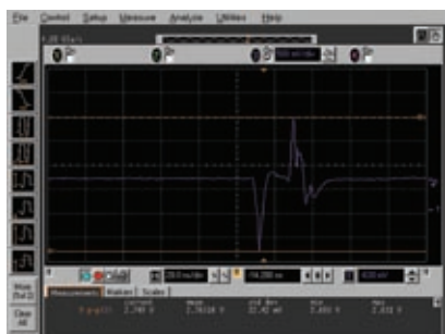
大多数 PIN 二极管开关的视频泄漏为 < 10Vpp
