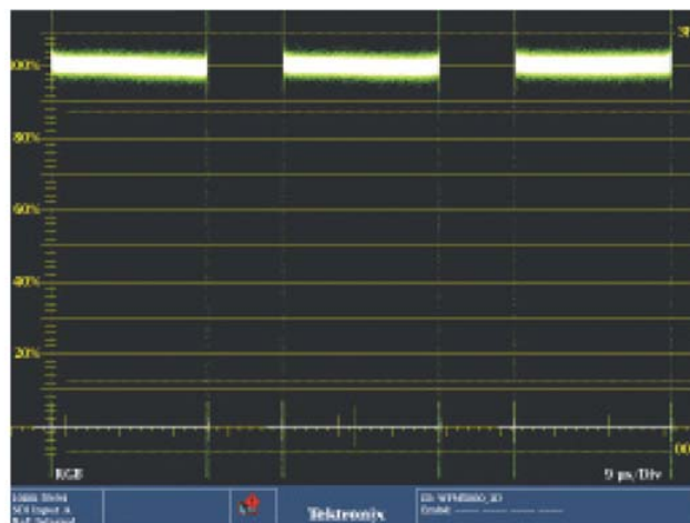
图 5. 摄像机的白平衡调整完成后的 WFM5000 波形显示。
