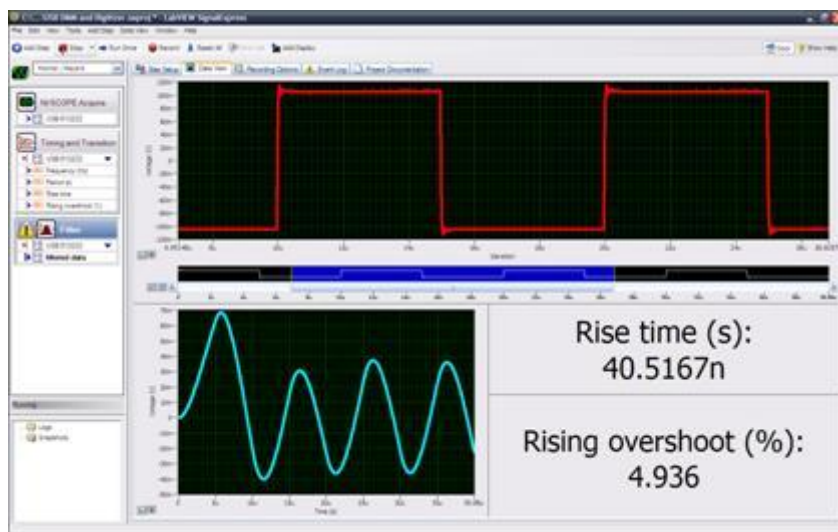
图 2. NI-5133 USB 数字化仪在时域测量中的性能表现
