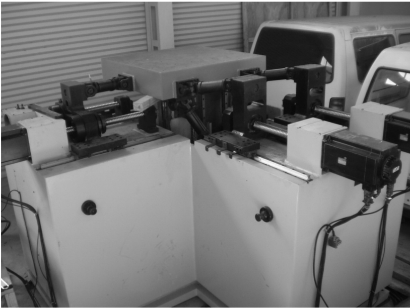
图2 D=10型地震模拟振动台样机
