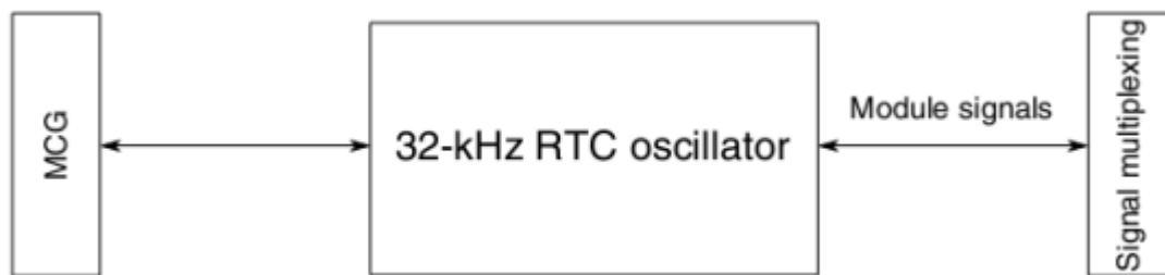
图 3-19 实时时钟振荡器配置
