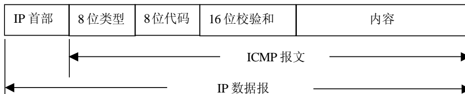
图15-11 封装在IP数据报内的ICMP报文
